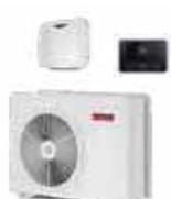
Bomba de calor ar/água reversível monobloco de alto rendimento e dimensões compactas com gás ecológico R32. Inclui SENSYS NET HD e sonda externa. Tecnologia monobloco: sem manipulação de gás refrigerante, só ligações hidráulicas. Conectividade ARISTON NET incluída de serie.
